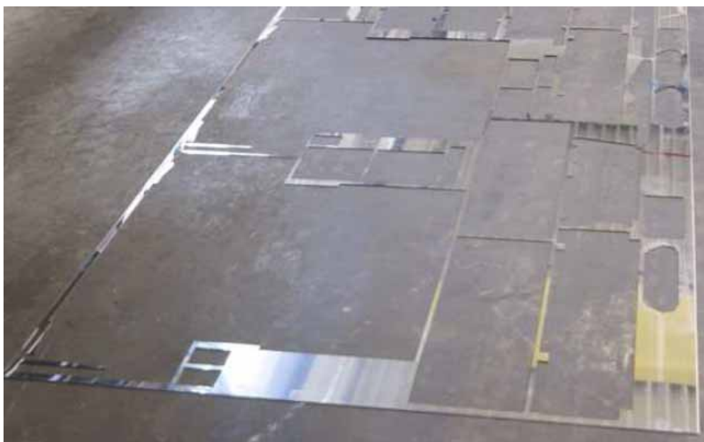
Stanzgitter bei der dynamischen Schachtelung, weniger Verschnitt geht kaum.
